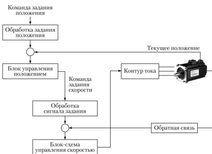
Рис. 2. Структурная схема управления сервоприводом.
